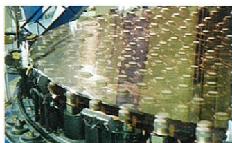
『すばる』の鏡面をコントロールする能動支持機構に音叉式センサ技術が採用されている。
