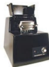
旧製品のMiniBeadbeater-1、8、16と同様、効率の高いホモジナイズ工程を採用しています。2mlバイアル48本または96ウェルマイクロプレート1枚にサンプルと大量の小さなセラミックビーズを充填し、2~3分間、激しく振動します。95%以上の細胞が破碎されます。マイクロプレートとビーズは使い捨てなので、サンプルの相互コンタミが許されないPAGE、PCR、プローブのアプリケーションに最適です。フェノール、グアニジンチオシアネートや様々な市販キットの試薬溶液を使用でき、細胞破碎と核酸抽出を同時に行うことによりRNA、DNAを最大収量で迅速に回収します。
