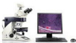
高画質で、インテリジェント自動制御機能を備えています。高輝度、最適な色の再現によって、サンプルの色の違いがよく分かる鮮明な画像を得られます。寿命が5万時間以上のLED照明は非常に費用効率が良く、頻繁なバルブ交換はもう必要ありません。透過光と蛍光照明のパラメータは、ユーザーの選んだコントラストの方法と倍率に合わせてインテリジェント自動制御機能によって設定されます。アポクロマートレンズで蛍光照明の光軸は完全に自動制御され、驚くほど美しいコントラストの鮮明画像が得られます。
