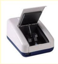
した測定モードと標準測定モードも備わっています。このデザインによって Jenwayの Genova Nanoシリーズの初期の3機種機能が1台に集約され、あらゆる実験ニーズに応えられるようになりました。Genova Nanoは、精度が高く、再現性に優れ、測定時間も短く、わずか0.5μl程度のサンプルの測定ができます。このように微量測定が可能なので、貴重なサンプルの使用量を軽減でき、希釈の必要性が減ります。また、キュベットを選ばません。洗浄は簡便・迅速で、読取ヘッドにサンプルが残らないようにマイクロファイバーの布で拭き取るだけなので、次の測定までの時間を短縮でき、効率を上げることができます。
