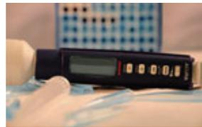
チップの付け外しが最適化され、低圧作動ボタンによってチップの取り外しが容易になりました。
