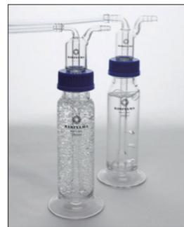
また、バブリング調節はネジの回数だけで行えます。桐山気泡可変型ガス吸収瓶は、化学、薬学、食品、香料など、各実験室で広汎にお使いいただけます。
