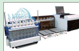
です。また脈動/無脈動可変送液用ポンプ、試験液切換機能や流量可変機能を組み合わせることで In Vivo/In Vitro 相関 (IVIVC) に適した試験条件の検討が可能です。
