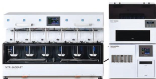
最新式の溶出試験器NTR-6600シリーズと、オートサンプラー、フィルターステーションによる溶出試験システム
