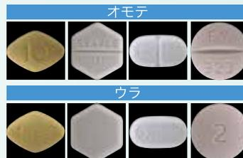
高精度カメラは、ターンテーブル上部と下部の2箇所に配置。表面・裏面で薬剤を撮影し、同時に印字・刻印の照合・識別処理を行います。また、識別された薬剤は、表裏や上下がそろえられた状態でPCに表示されます。
